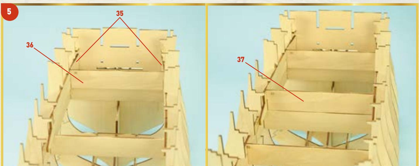
**5** Вклейте распорки (36) и (37) в соответствующие пазы деталей (35). Наносите клей только на места соединения этих четырех деталей. Затем продвиньте вперед конструкцию, образованную склеенными деталями (35), (36) и (37), так чтобы передние концы стрингеров (35) уперлись в носовую переборку. После этого приклейте стрингеры (35) к переборке.
