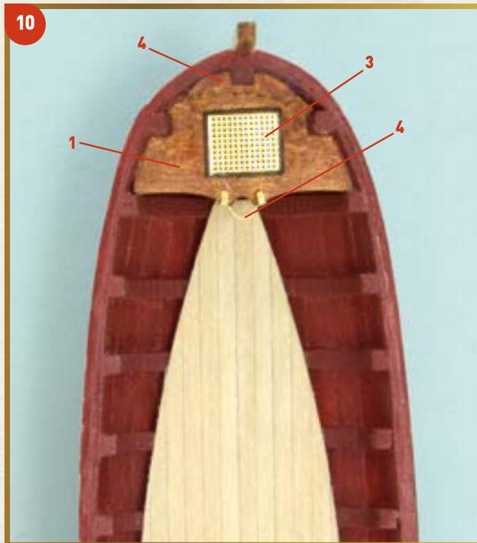
**10** Извлеките из матрицы металлическую пластину № 4 и согните ее так, как показано на фотографии, после чего приклейте эту пластину к детали № 1. И, наконец, приклейте на свои места в шлюпке деревянные детали №№ 1 и 4, а также металлическую деталь № 3.
