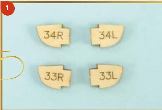
**1** Мы продолжаем работу над каркасом модели. Извлеките детали (33L), (33R), (34L) и (34R) из деревянной матрицы, которую вы получили с этим выпуском. Данные детали являются кницами и служат для крепления бортовых стрингеров каркаса.
